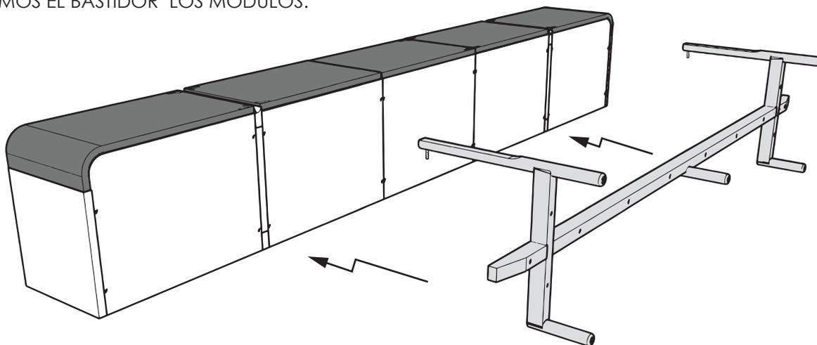
**7** SUJECIÓN DEL BASTIDOR MACIZO DE LAS PATAS AL CONJUNTO DE LOS MÓDULOS.
